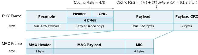
Fig. 7. LoRa<sup>TM</sup> packet structure
